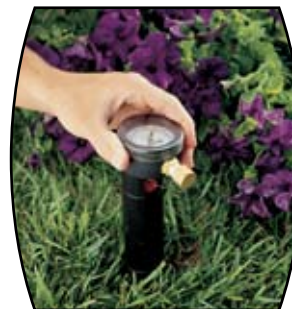
A FORGÓFEJ PITOTCSÖVES LÉGNYOMÁSMÉRŐJE
